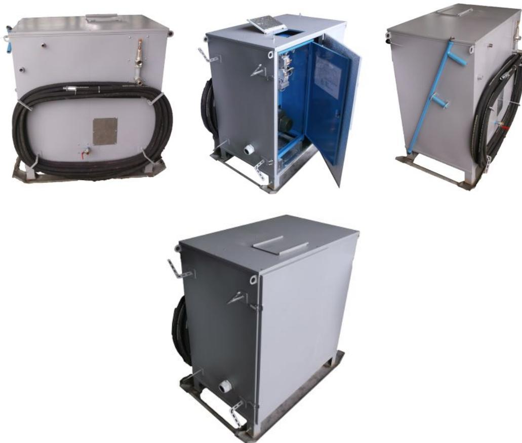
Данная модель разработана нашей компанией для использования в зимнее время года на улице. Конструкция - утепленный блок-бокс с подогревом, собственным баком (небольшого объема) и электродный парогенератор внутри. Исполнение - морозоустойчивое, с возможностью повторного использования отработанного конденсата.
