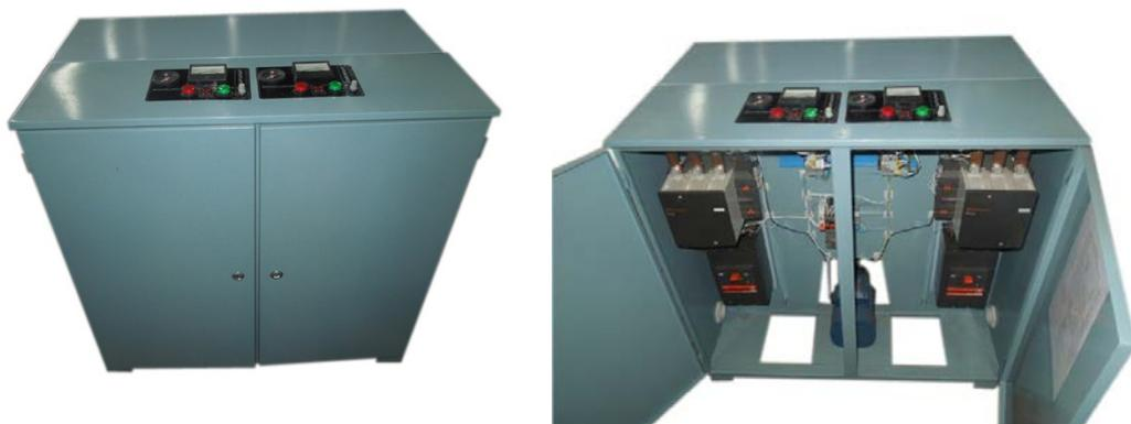
ПГЭ-400 электродный парогенератор мощностью до 300 кВт и паропроизводительностью пара до 400 кг/ч, с плавным управлением мощности от 12 до 100%. Максимальное давление пара 5,5 кг/см<sup>2</sup> (10,0 кг/см<sup>2</sup>) и с температурой пара до 158°С (180°С).
